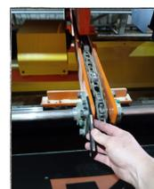
PEÇA NO FORMATO SETA POSICIONADO NA FRENTE DA MAQUINA E PRESO A GUIA MÓVEL, SERVE PARA QUE POSSA SE IDENTIFICAR VISUALMENTE O PONTO DE DESLOCAMENTO DA LINHA SEM PRECISAR SEMPRE DE UMA ESCALA MÉTRICA EM MÃOS (PRECISA SER FEITO A GRAVURA EM ESCALA CONFORME A PRODUÇÃO DE CADA CLIENTE)
