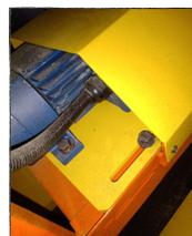
PLACA DE FIXAÇÃO DOS MOTO SERRAS COM FUROS OBLONGADOS QUE PERMITE A VOCÊ FAZER UM FINO AJUSTE NO TAMANHO DO SEU LIXO DEIXADO NO DESTOPO
