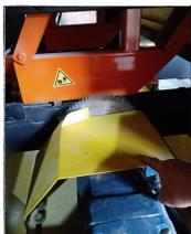
PROTEÇÃO DO MOTO SERRA LADO FIXO FABRICADO EM AÇO CHAPA ELE TEM A FINALIDADE DE NÃO DEIXAR OS TOCOS RESULTANTES DO DESTOPO ENTRAR ENTRE A SERRA, CONTEM UMA RÉGUA COLOCADA EM ANGULO PARA DESVIAR OS TOCOS PARA CAÍREM NA CALHA DE LIXO
