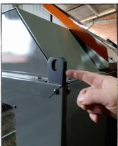
4 PEÇAS EM AÇO 1020 OXI-CORTADO COM FURO CONFORME
