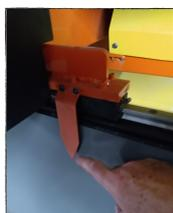
DISPOSITIVOS FABRICADOS EM AÇO E FIXO NA ESTRUTURA SUPERIOR AS SERRAS COM A FINALIDADE DE CALCAR AS TABUAS AO PASSAR PELA SERRA COM O OBJETIVO DE NÃO A TRAVESAR OU DESESTABILIZAR O CORTE
