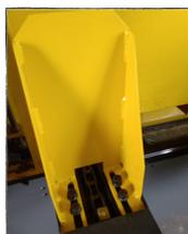
TORRES DO MAGAZINE UM DISPOSITIVO FABRICADO EM CHAPAS SOLDADAS E COM FURAÇÃO OBLONGADAS QUE PERMITE REGULAR A LARGURA DAS TABUAS A SEREM PRODUZIDAS (PÓS A REGULAGEM APERTAR OS PARAFUSOS DE FIXAÇÃO DAS DUAS TORRES)
